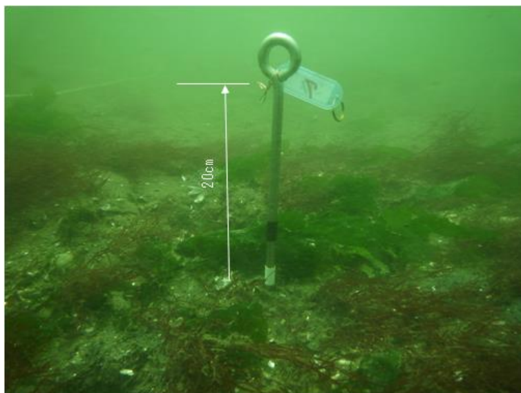
写真-4.1.4 浅場表層砂の移動測定用鉄筋杭
