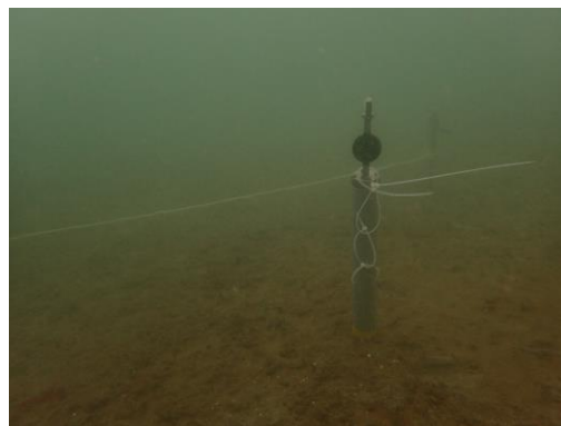
写真-4. 3. 10 流向流速計の設置
