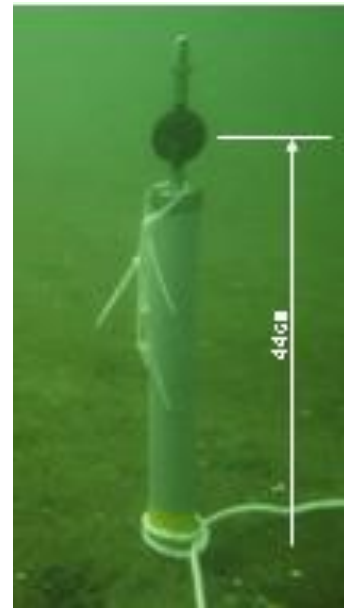
写真-4.1.3 流向流速計の設置
